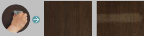
LiviE 表面にスチールウールをこすりつけても、ほとんど傷が付いていません。 従来シリーズ
